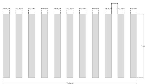
MARCA PARA SEÑALAMIENTO DE PASO PEATONAL, LINEA DE 40CM DE ANCHO, CON SEPARACIÓN EQUIDISTANTE DE 40 CMS DE ANCHO DE LONGITUD, ELABORADO A BASE DE CONCRETO HECHO EN OBRA F'c=200 KG/CM2 CON ESTRIADO DE 3CM @1.2CM CON BASE DE AGREGADOS PÉTREOS, COLOR INDELEBLE QUE GARANTICE EL MISMO TONO DESPUÉS DE 1 AÑO, SEGÚN FICHA DE DESPIECE TÉCNICA.
