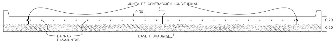
SECCIÓN TRANSVERSAL DE LOSA DE CONCRETO
