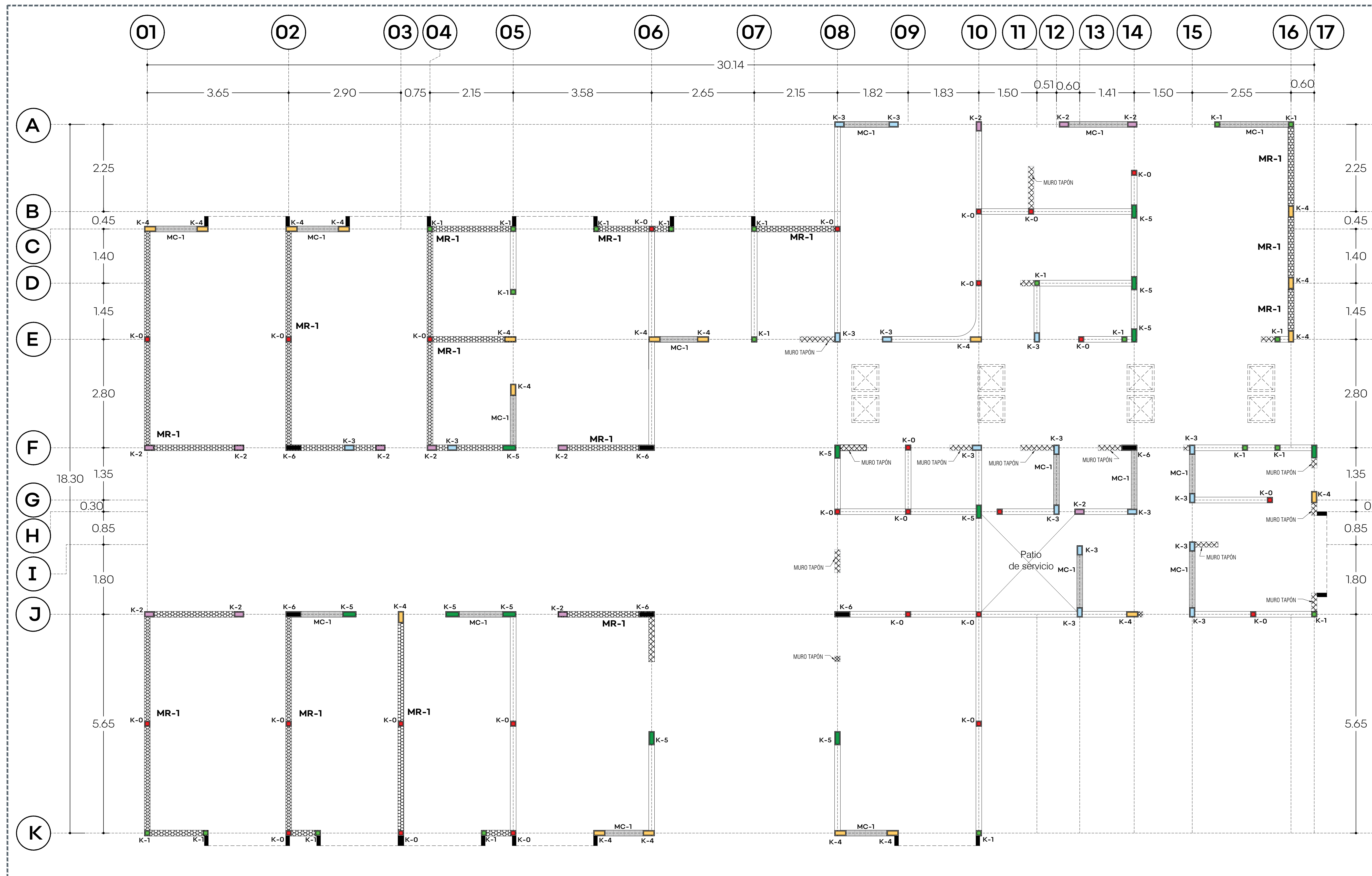
01 PLANTA DE LOCALIZACIÓN DE MUROS Y CASTILLOS
