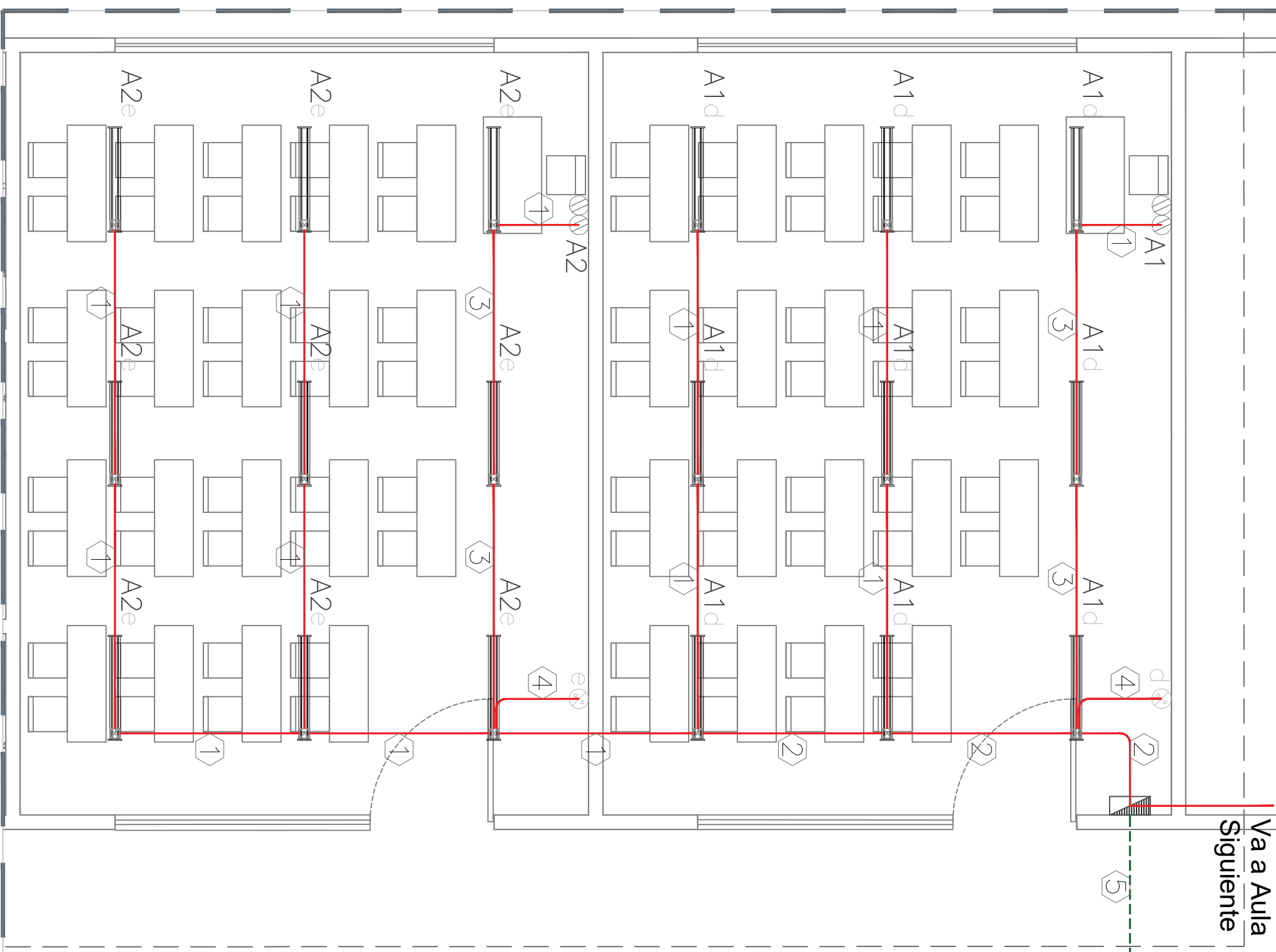
01 Instalación eléctrica e iluminación aulas tipo 150
