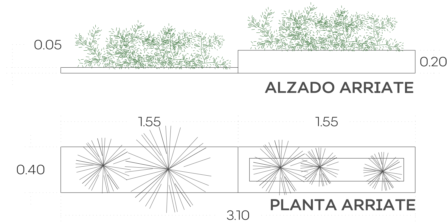
02 DETALLE DE ARREATE EN BANQUETA
